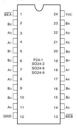
PDIP/ SOIC/ QSOP/ TSSOP TOP VIEW
