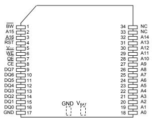
34-Pin PowerCap Module (PCM) (Uses DS9034PC PowerCap)
