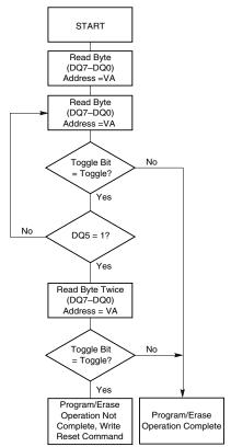
**Note:** The system should recheck the toggle bit even if DQ5 = "1" because the toggle bit may stop toggling as DQ5 changes to "1." See the DQ6: Toggle Bit I and DQ2: Toggle Bit II for more information.
