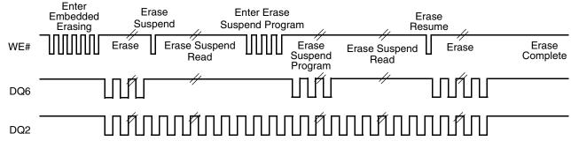
**Note:** Note: DQ2 toggles only when read at an address within an erase-suspended sector. The system may use OE# or CE# to toggle DQ2 and DQ6.
